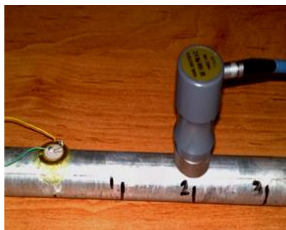
شکل (۲): لوله تحت آزمایش به‌همراه کریستال پیزوالکتریک و پراب اولتراسونیک دریافت‌کننده.
